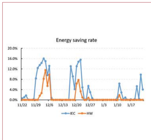
Comparison of efficiency in energy recovery of indirect evaporative cooler with heat wheel Comparaison de l'efficacité de la récupération d'énergie du refroidisseur à évaporation indirecte avec roue thermique
