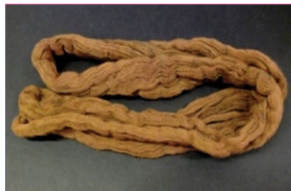
As-made PMANa-assisted copper-coated cotton yarns Fils de coton recouverts d'une couche de cuivre par PMANa-ainsi faits
